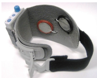
Figurer 9 og 10: Bytte elektrodene (sett innenfra og utenfra)
